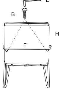
Befestigen Sie den U-Balken **#F** mit Schrauben **#B** an die Rücklehne **#H**.
