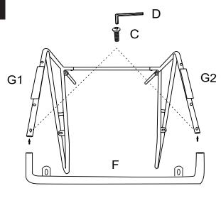
Verbinden Sie die Gestelle **#G1 #G2** mit U-Balken **#F** zusammen. Befestigen Sie sie mit Schrauben **#C**.
