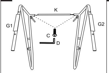
Verbinden Sie die rechtes Bein **G1** und linkes Bein **G2** mit Stange **#K**. Befestigen Sie sie mit Schrauben **#C**.
