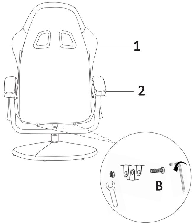
Verbinden Sie die Rückenlehne #1 und den Sitz #2 mit Schrauben #B.
