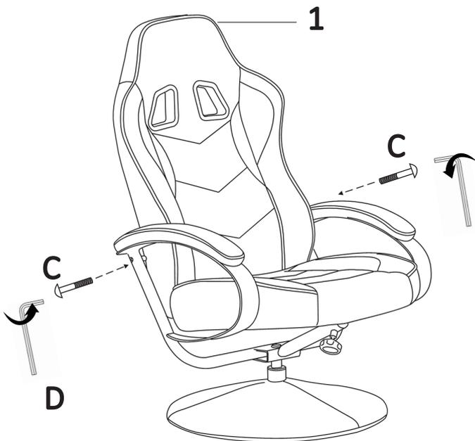
Befestigen Sie die Rückenlehne #1 mit Schrauben #C.
