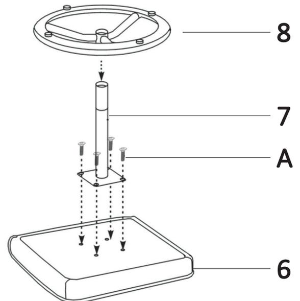
Befestigen Sie die Säule #7 an den Sitzpolster #6 mit Schrauben #A.
