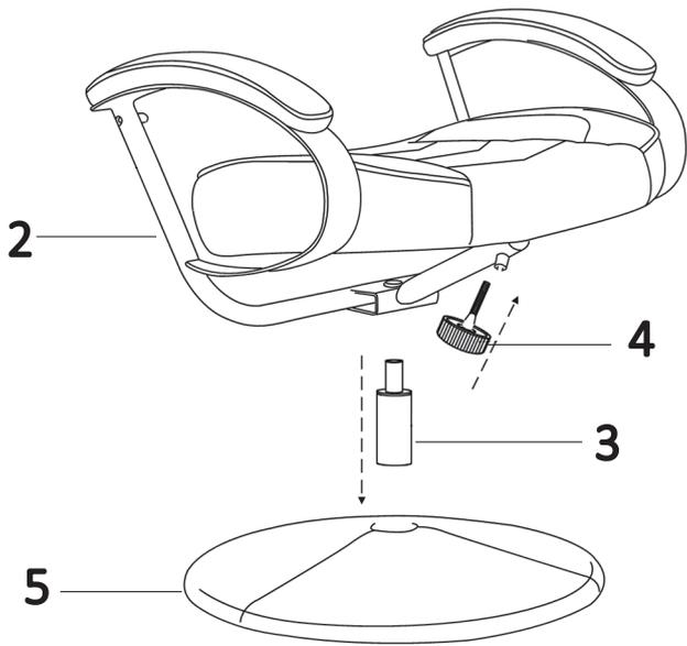
1.1 Besetzen Sie die Gassäule #3 an die Basis #5, den Sitz #2 an die Gassäule #3.
