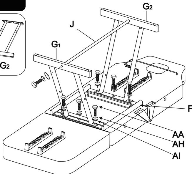
3.1 Befestigen Sie die Gestelle (G1/G2) mit Schrauben (AA/AH/AI) am Gestell (F).
