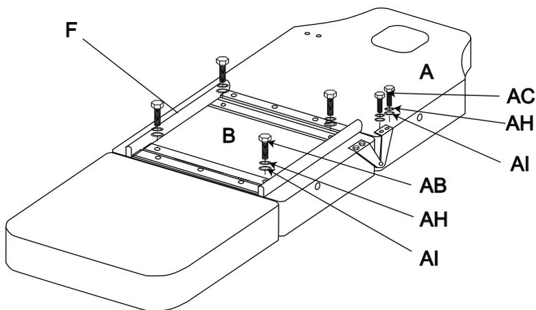
1.1 Verbinden Sie die Rückenlehne (A) und den Sitzpolster (B) mit Schrauben (AC/AH/AI).
