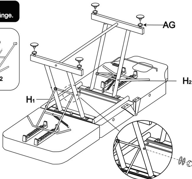
4.1 Befestigen Sie die T-Balken mit langer Feder (H1) mit den vorinstallierten Schrauben am Gestell (G1) und die T-Balken mit kurzer Feder (H2) am Gestell (G2) .
