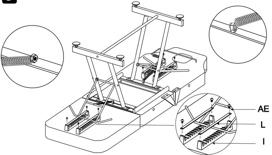
5.1 Legen Sie die T-Balken (H1/H2) zwischen die Zackenstreifen (I) und befestigen Sie die Aluminiumblech (L) mit Schrauben (AE) daran.
