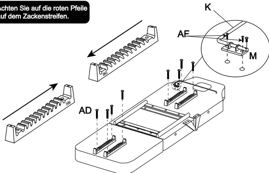
2.1 Befestigen Sie die Zackenstreifen (I) an der Rückenlehne und Beinstütze mit Schrauben (AD).
