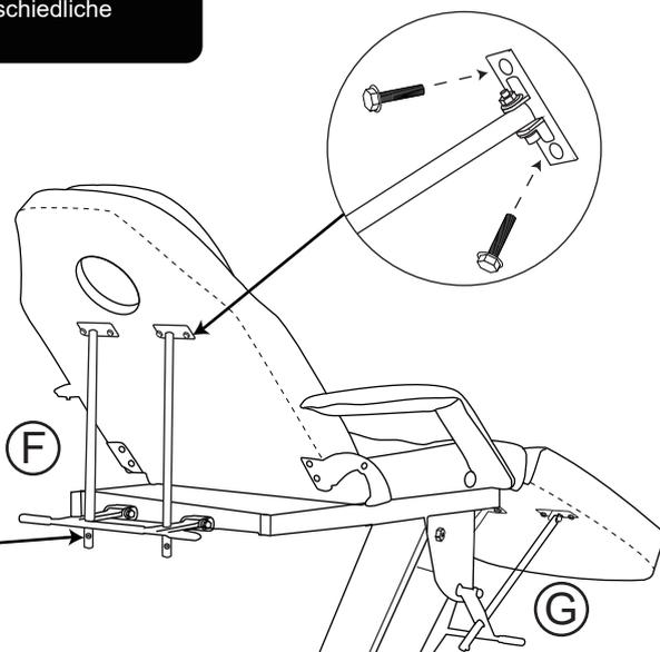
Befestigen Sie die Stützstangen I (#F) an der Rückenlehne und die Stützstangen II (#G) an der Beinstütze.
