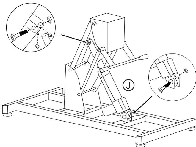
Befestigen Sie den Motor (#J) mit den Schrauben vorinstalliert.
