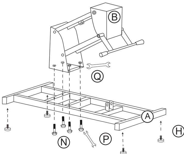
Befestigen Sie die Stützstifte (#H) an der Basis(#A).
