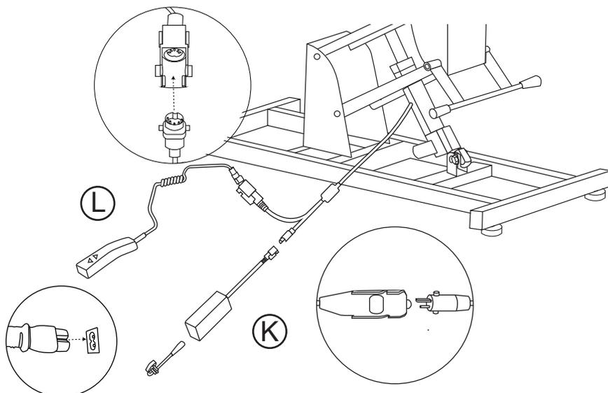
Verbinden Sie den Adapter (#K) und die Fernbedienung (#L) mit dem Motor (#J).
